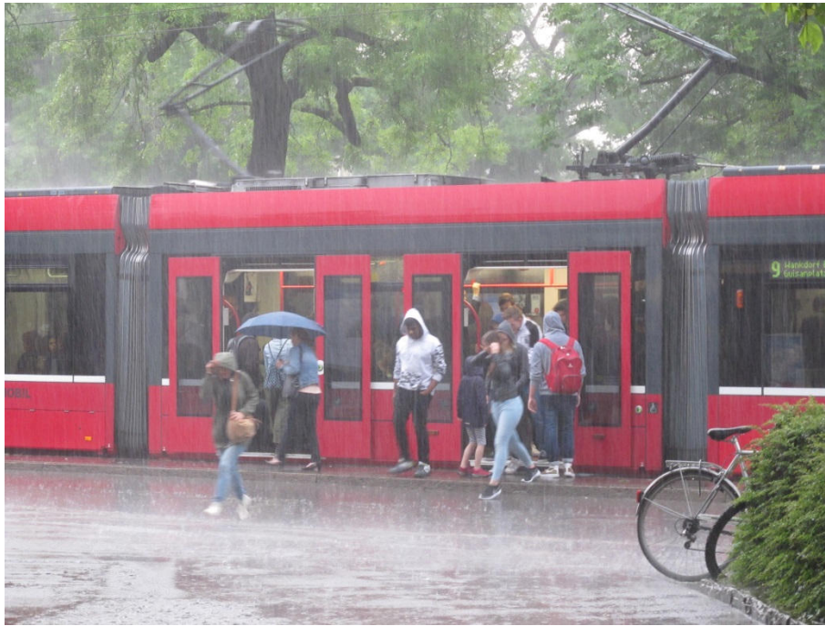
Bild 42: Haltestelle Viktoriaplatz, Bern: kein Warteraum in Mittellage und zu kurzer Haltestellenbereich
